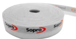
Selbstklebender Randdämmstreifen aus geschlossenzelligem, unverrottbarem, vlieskaschiertem Polyethylenschaumstoff. Für den Anschlussbereich Boden/Wand zur Vermeidung von Mörtelbrücken. Einsatz in Verbindung mit Sopro Fliesenklebern und selbstnivellierenden Fließpachtelmassen sowie dem Einbau von Sopro FliesenDämmplatten, Sopro TrittschallDämmplatte und Sopro Trittschall- und Entkopplungsbahn.
