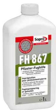
In Wasser gelöstes, hochalkalisches Produkt zur vorübergehenden Hydrophobierung von saugfähigen Pflastersteinen aus Beton- und Naturwerkstein. Die Flächen lassen sich dadurch leichter verfugen. Sopro Pflaster-Fughilfe dringt in das Kapillarsystem des mineralischen Pflastersteines ein und rüstet ihn wasserabweisend aus. Dadurch lassen sich Pflasterfugenmörtel leichter abwaschen. Auch als Abwaschhilfe für polygonal verlegte Naturwerksteine im Wand- und Bodenbereich.
