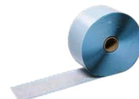
Selbstklebendes, rissüberbrückendes Universal-Dichtband auf Butyl-Kautschukbasis für den oberen Bahnenabschluss bei senkrechten Flächen sowie den Bahnenabschluss bei waagerechten Flächen der Abdichtung in Verbindung mit SoproThere® Bitumenabdichtungsbahn. Oberseite mit synthetischer Vlieskaschierung zum einfachen, kraftschlüssigen Überputzen bzw. Überkleben.
