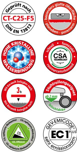
Selbstnivellierende, schnell erhärtende, zementäre Fließspachtelmasse. Zur Herstellung besonders ebener, glatter und ansatzfreier Flächen in dünnen Schichten und zur Kratzspachtelung. Für nachfolgende Belagsarbeiten aller Art. Ideal für elastische Beläge wie Designvinylbeläge, Linoleum und PVC, textile Beläge sowie Parkett und Laminat. Geeignet für Stuhlrollenbelastung ab 2 mm Schichtdicke.
