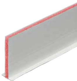
Selbstklebendes Profil aus geschlossenzelligem, unverrottbarem, zweiseitig folienkaschiertem Polyethylenschaumstoff. Zur spannungsabbauenden Begrenzung von Feldern und Ausbildung von Fugen. Einsatz in Verbindung mit Sopro Fließspachtelmassen sowie beim Einbau von Zement- und Calciumsulfatestrichen, insbesondere Sopro Rapidur® FE und SoproTherm® FE NEO.
