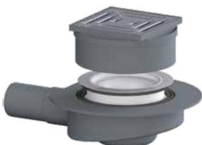
Hochschlagfestes Ablaufgehäuse aus Polypropylen. ShowerBase Point Ablauf passend zu den XPS-Duschelementen mit Punktentwässerung. Ablauf waagrecht flach DN 40.
