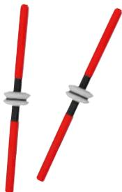
Edelstahlverstärkter, kunststoffummantelter, flexibler Spezialdübel. Zum nachträglichen Verbinden von Estrichtrenn- und Bewegungsfugen. Verhindert Höhenversätze aneinander liegender Estrichscheiben. Auch als Höhenversatzisen/ Anschlussverdübelung zum Einbau in frische Estriche.
