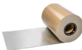
Selbstklebendes, UV-beständiges Aluminium-Abschlussband, beschichtet mit einer stark klebenden Bitumen-Kautschukmasse für den oberen Bahnenabschluss bei senkrechten Flächen sowie den Bahnenabschluss bei waagerechten Flächen in Verbindung mit SoproThere® Bitumenabdichtungsbahn.
