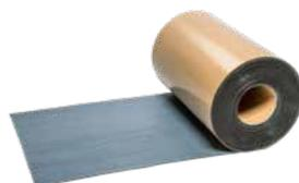
Doppelseitig selbstklebendes, selbstverschweißendes, reißfestes Klebeband aus einer stark klebenden Bitumen-Kautschukmasse für den waagerechten Überlappungs- und Stoßbereich sowie zur sicheren Abdichtung von komplizierten Details wie z. B. Rohrdurchführungen und Bodeneinläufen in Verbindung mit SoproThere®.
